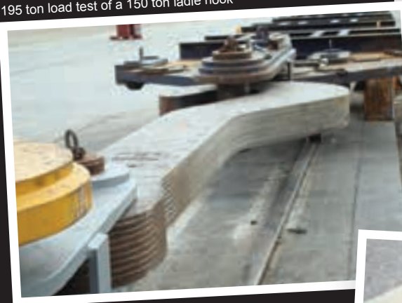
195 ton load test of a 150 ton ladle hook
